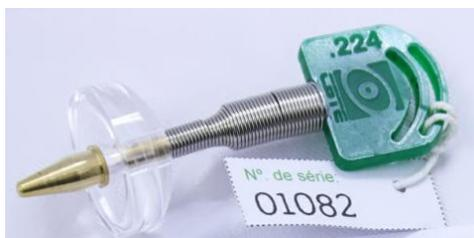
No caso dos calibres maiores, deve-se utilizar os calibradores dos respectivos calibres permitidos na prova. A imagem abaixo apresenta exemplos dos possíveis calibradores que podem ser utilizados na apuração das provas.
